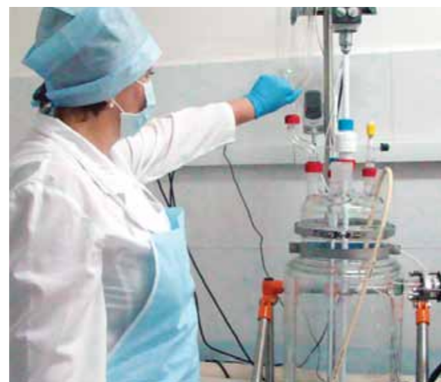
Реакторная установка с температурным датчиком
