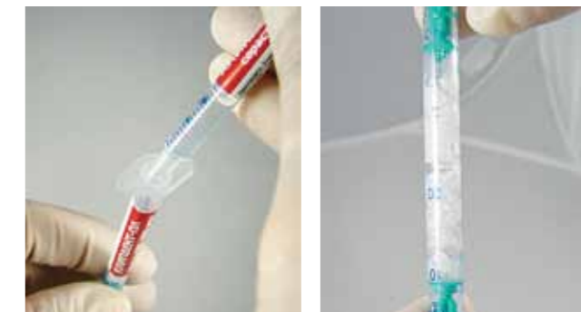
Гранулы в шприце смачиваем соразворителем, в результате чего они склеиваются между собой
