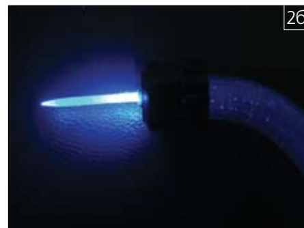
■Рис. 2. Светопроводимость импортного штифта (а) и штифта “Армодент” (б)
