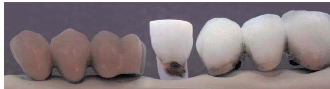
Рис. 14. Внешний вид протезов, изготовленных из стоматологической керамики с добавлением УФ пигмента, без него и экстрагированного человеческого зуба, при облучении их УФ излучением с \lambda_{exc.} = 360 \text{ nm}
